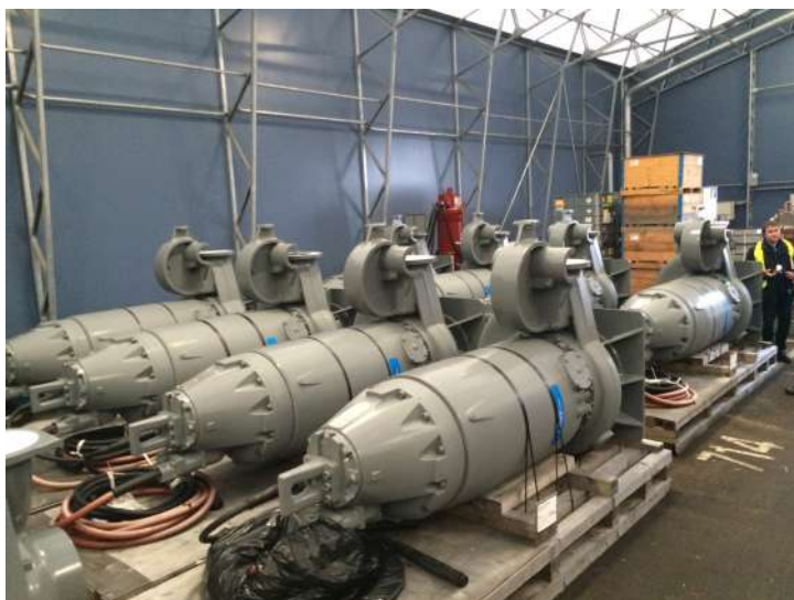
Двухсекционный блок обратного водоснабжения (БОВ-7). ОАО "Газпромнефть-Московский НПЗ". 10 высоковольтных насосов Flygt CP3351.985, производительностью 2300 м³/ч каждый
