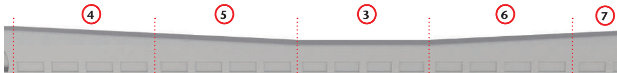
Канал переменной высоты с уклоном 5 % (2 элемента)
