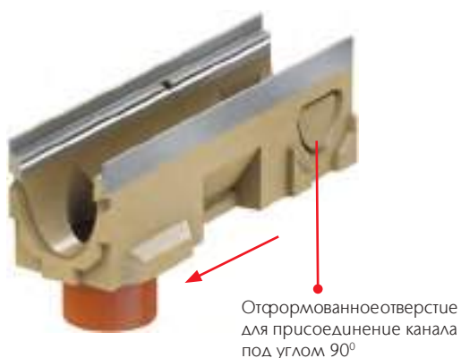
Выпуск из дна канала производится через отверстие с резиновым уплотнителем.
