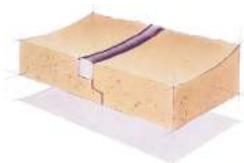
Герметичный стык системы ACO
