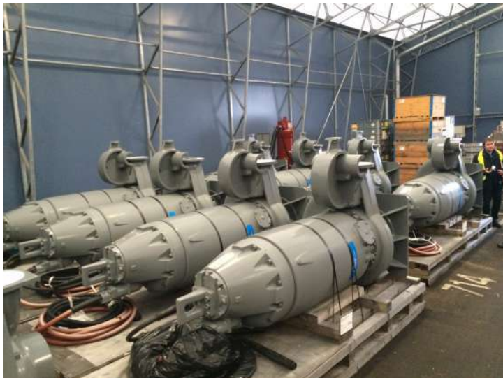
Двухсекционный блок обратного водоснабжения (БОВ-7). ОАО "Газпромнефть-Московский НПЗ". 10 высоковольтных насосов Flygt CP3351.985, производительностью 2300 м 3 /ч каждый
