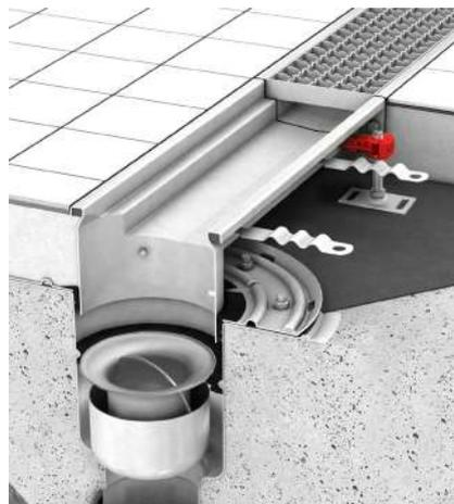
**Покрывтие пола плиткой.** Выпускной канал с телескопическим трапом с вертикальным отводом и зажимным фланцем для гидроизоляции
