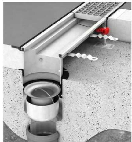
**Виниловое покрытие пола.** Выпускной канал с телескопическим трапом с вертикальным отводом без возможности заведения гидроизоляции в корпус трапа. Кант канала с виниловым уплотнителем для герметичного примыкания винилового пола к канту канала.
