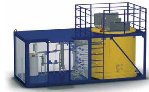
Мембранный биореактор с насосной станцией
