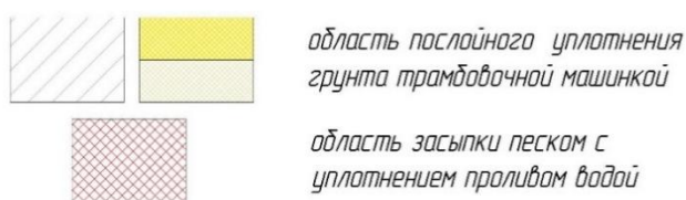
Рисунок 13 – Области ручной и механической трамбовки
