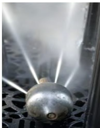
Рис. 49. Гидродинамическая промывка резервуаров ACO StormBrixx
