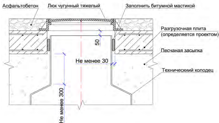
Рис. 33. Узел примыкания разгрузочной плиты с горловиной ИК.
