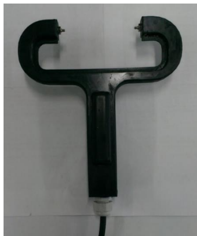
Рисунок 4 – датчики песка, нефтяной пленки и переполнения (воды)
