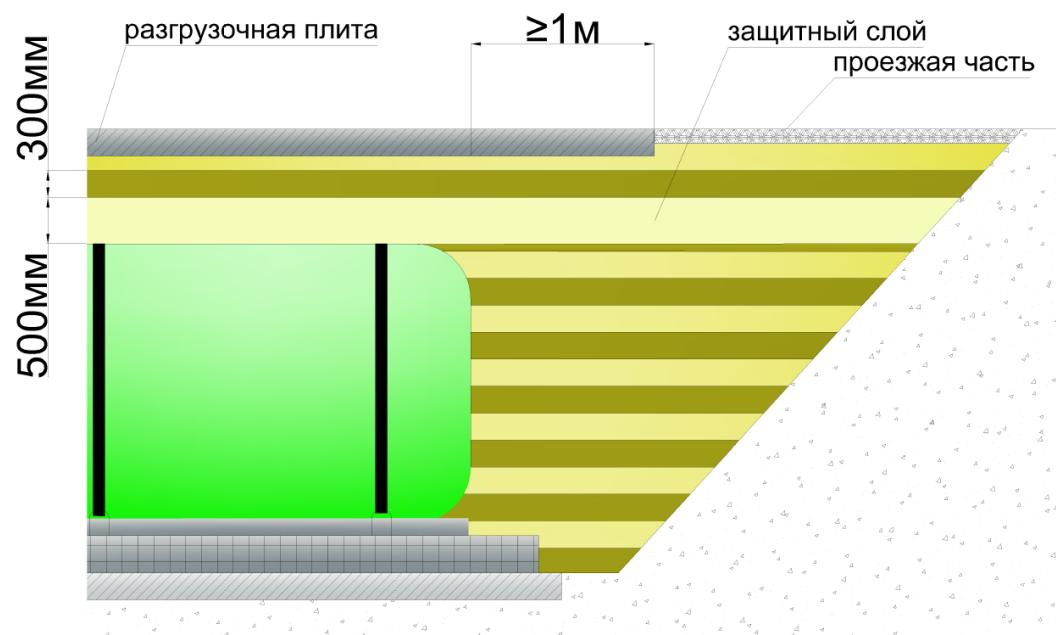
Рисунок 15 – Монтаж корпуса под проезжую часть
