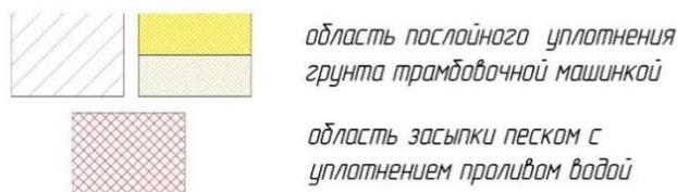
**Рисунок 18** – Области ручной и механической трамбовки
