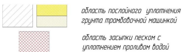
Рисунок 17 – Области ручной и механической трамбовки
