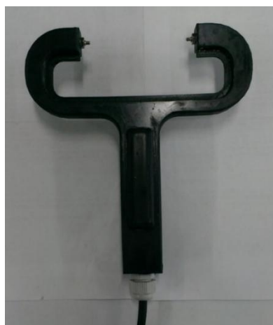
Рисунок 4 – датчики песка, нефтяной пленки и переполнения (воды)
