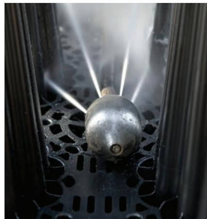
Промывка производится гидродинамическим способом:
