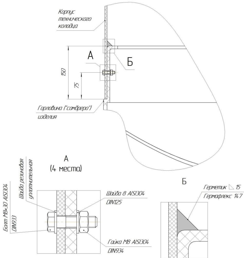
1. Болтовые соединения установить равноудаленно по окружности технического колодца
