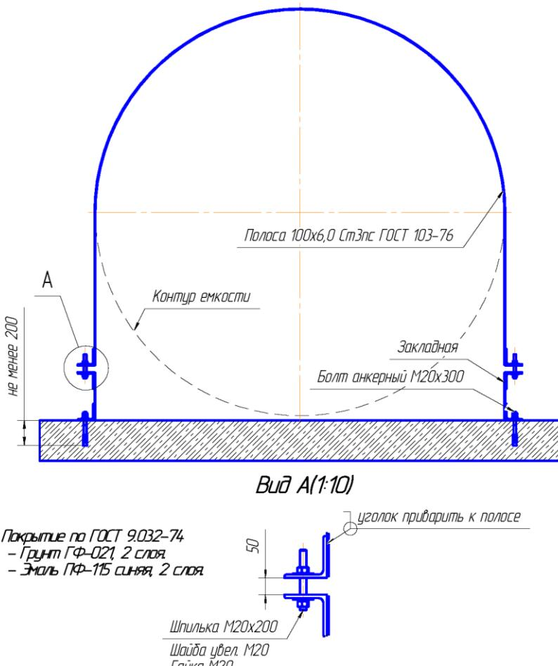
**Рисунок 1 – Рекомендации по анкеровке стяжных металлических лент**
