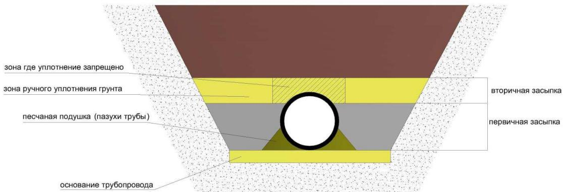
**Рисунок 10 – Засыпка трубопроводов**
