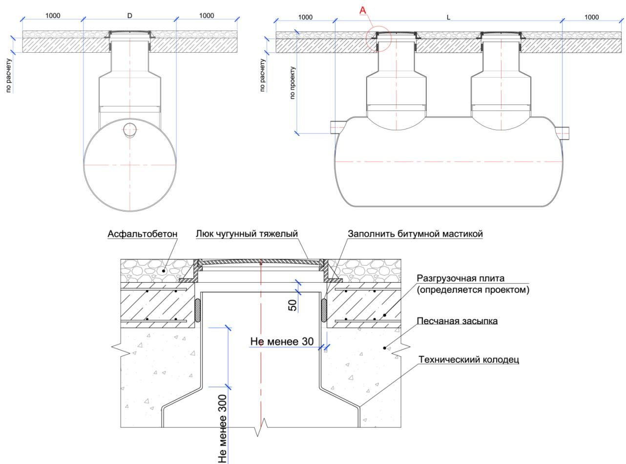
**Рисунок 11** – Пример монтажа под проезжую часть
