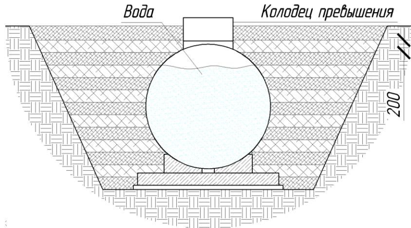
**Рисунок 6 – Обратная засыпка установки**
