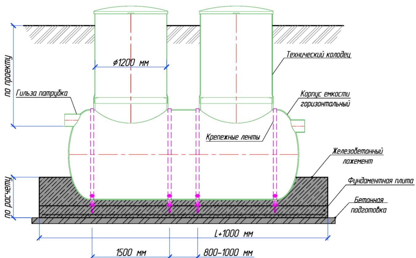
**Рисунок 2 – Крепление горизонтального изделия к фундаментной ж/б
