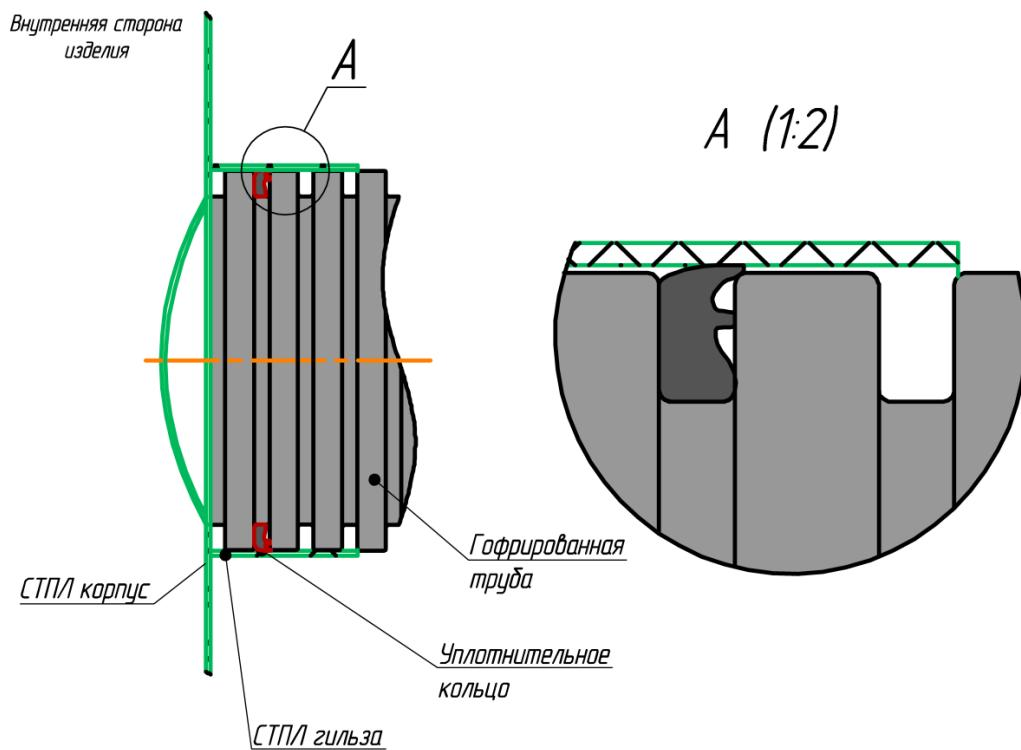
**Рисунок 8 – Герметизация гофрированной трубы в гильзе с помощью уплотнительных колец**
