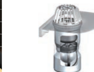
Выпускной элемент для прямки с корзиной для улавливания листьев, гидрозатвором и клапаном от обратного подпора, арт. 310060
