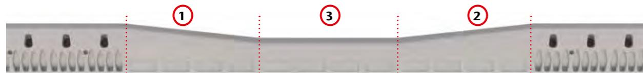
Канал переменной высоты с уклоном 10 % (1 элемент)
