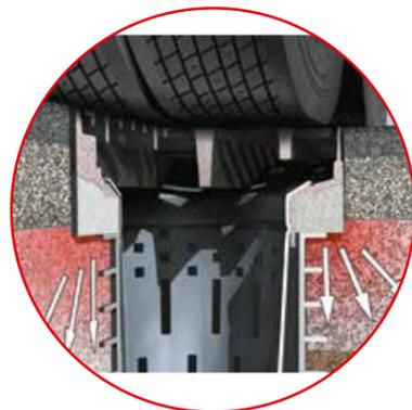
Нагрузка от колеса автомобиля передаётся непосредственно на грунт, а не на корпус дождеприёмника.
