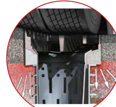
Нагрузка от колеса автомобиля передаётся непосредственно на грунт, а не на корпус дождеприёма.
