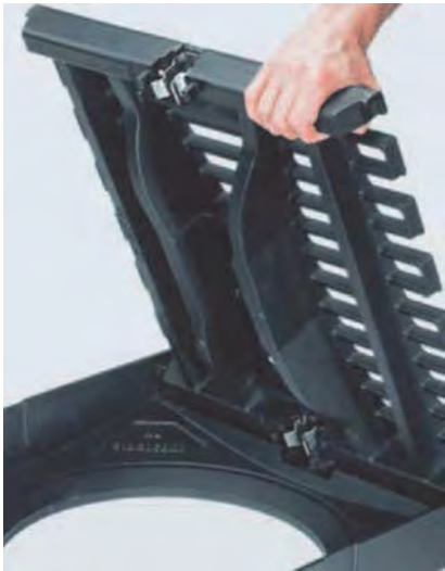
Площадь водоприемных отверстий: Решетка 300x500 мм, прямая: 750 см². Решетка 300x500 мм, вогнутая: 740 см². Впускная секция: Решетка 500x500 мм, прямая:1180 см². Решетка 500x500 мм, вогнутая: 1170 см².
