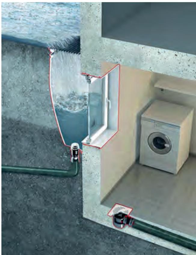
Приямки ACO Therm® производятся с выпускным отверстием DN100. Вода отводится из приямка через выпускное отверстие в систему дождевой канализации.
