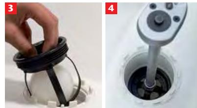
3 Установить клапан в нижнюю часть корпуса выпускного элемента. Соединение затянуть с помощью инструмента.
