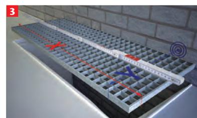
3 Измерьте ширину решетки (размер X) и глубину решетки, добавив расстояние от стены до решетки (размер Y). По этим размерам соберите раму из алюминиевого профиля.
