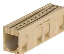
Канал ACO Monoblock PD 200 натурального цвета, длина 1 м, ширина щели 15 мм
