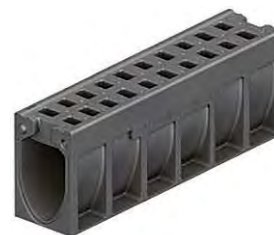
Канал ACO Monoblock RD 150 черного цвета длиной 1 м, класс нагрузки F 900
