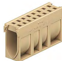
Канал ACO Monoblock RD 200 натурального цвета длиной 1 м, класс нагрузки F 900
