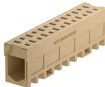
Канал ACO Monoblock RD 300 натурального цвета длиной 2 м, класс нагрузки F 900
